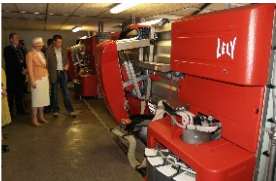
Robotmalke systemet fra Lely er fuldautomatisk, ordner alt selv. Køerne står på den anden side. Selv påsætning af pattekopper sker automatisk.
